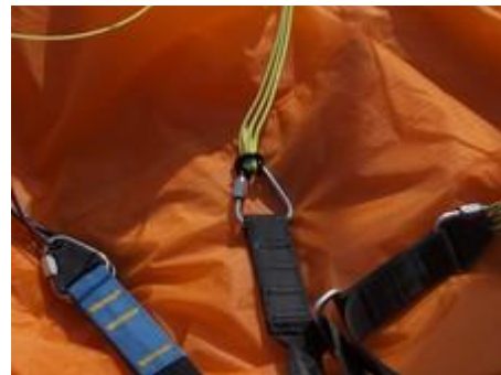
Das von uns präparierte Leinenschloss; verschraubt und mit einem O-Ring gesichert
